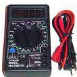
Nos multímetros digitais não é necessário realizar qualquer calibração. Os multímetros digitais apresentam os resultados diretamente no display, necessitando apenas que escolha a escala de resistência mais adequada antes da medição.
